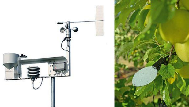
13.ábra Meteorológiai állomás (balról) és levél nedvesség szenzor (jobbról)
