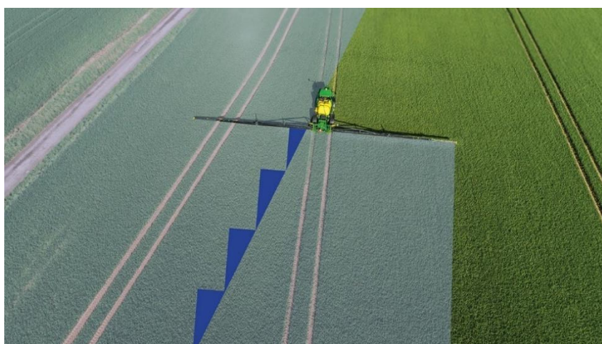
23. ábra Szakaszvezérlés a növényvédelemben
