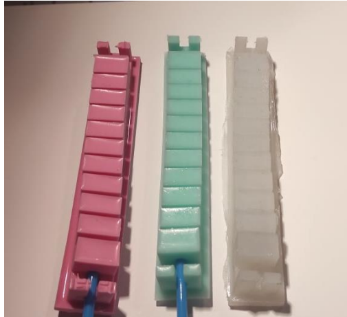
15. ábra: A háromféle szilikonból elkészült aktuátorok: Mold Max 30, Mold Max 40, Ecoflex 00-50 (balról jobbra)
