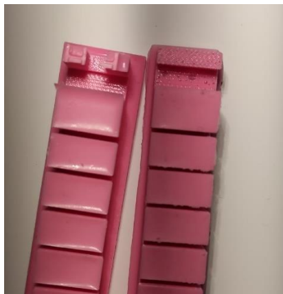
14. ábra: Vákuumozott és vákuumozás nélküli szilikonok összehasonlítása
