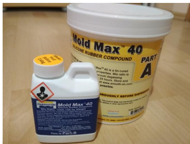
7. ábra: Mold Max 40 szilikon két komponense
