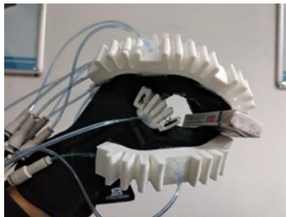
6. ábra: Kesztyűre rögzített soft aktuátor kisméretű tárgy megfogása közben
