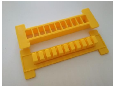
13. ábra: Kamrasor 3D nyomtatott öntőformája
