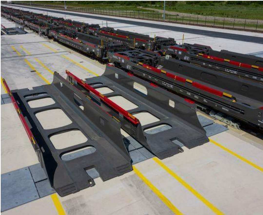
Cargobeamer átrakási technológiájú terminál és vasúti kocsi
