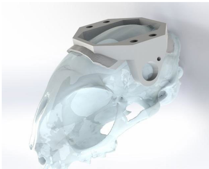
5. ábra - A 3D koponyamodel és az optikai szálak laterális penetrációját támogató krónikus implantátum SolidWorks környezetben
