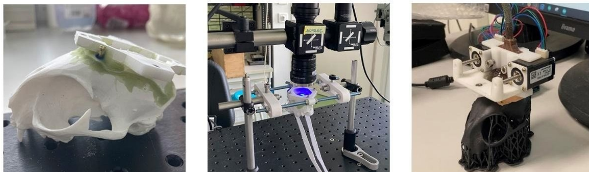
9. ábra - A fejlesztési folyamat egy-egy lépése. Bal oldali kép: A Palacos csontcementtel és fogászati csavarokkal rögzített implantátum a 3D nyomtatott koponyamodellen. Középső kép: A fejrögzítő rendszer tesztelése széles látószögű képalkotással. Jobb oldali kép: A motorikus modul tesztje az összeszerelést követően.
