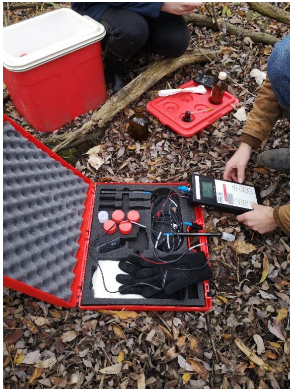
11.1.1. ábra: Kézi pH- és vezetőképesség-mérő készülék terepi kalibrálása (HEGYI V. ÉS NEHR N. 2021)
