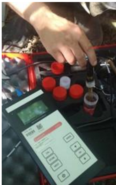
11.1.2. ábra: Kézi mérőműszer és oldott oxigén kicsapatás(HEGYI V. ÉS NEHR N. 2021)
