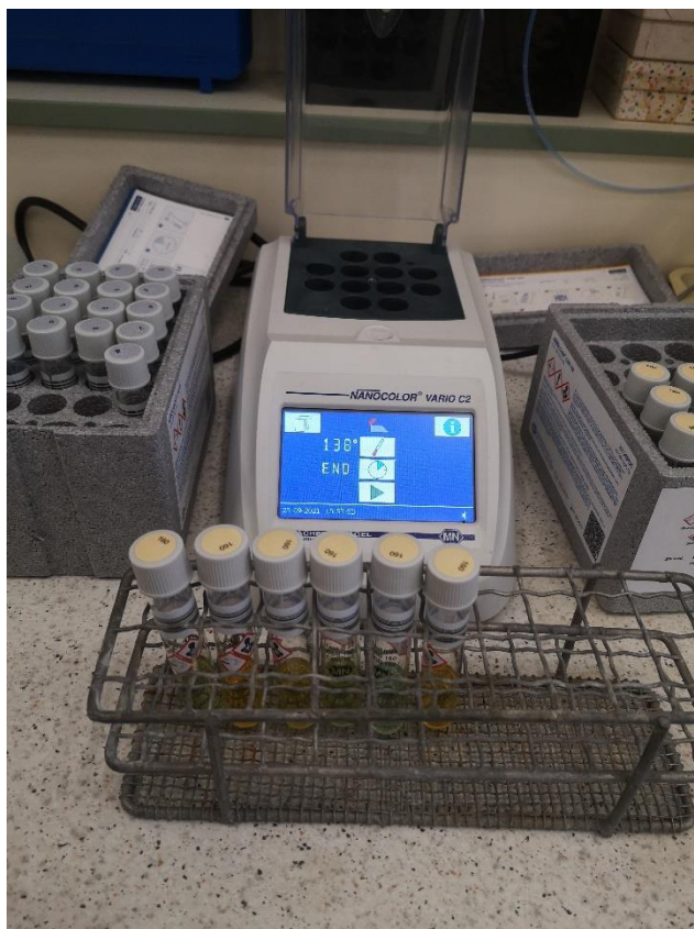
11.1.15. ábra: KOI mérése laborban (HEGYI V. ÉS NEHR N. 2021)
