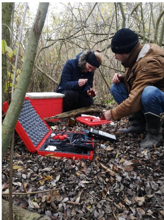
11.1.3. ábra: Oldott oxigén terepen való kicsapatása (HEGYI V. ÉS NEHR N. 2021)
