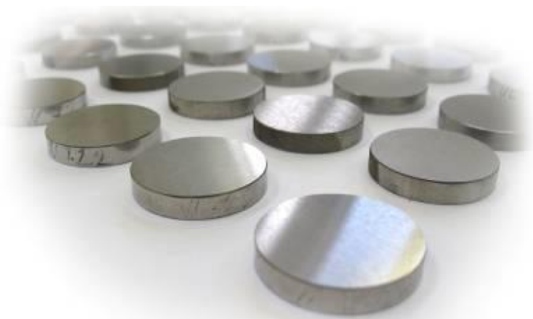
11. ábra. A polírozott vizsgálati minták geometriája és felületi minősége [22]
