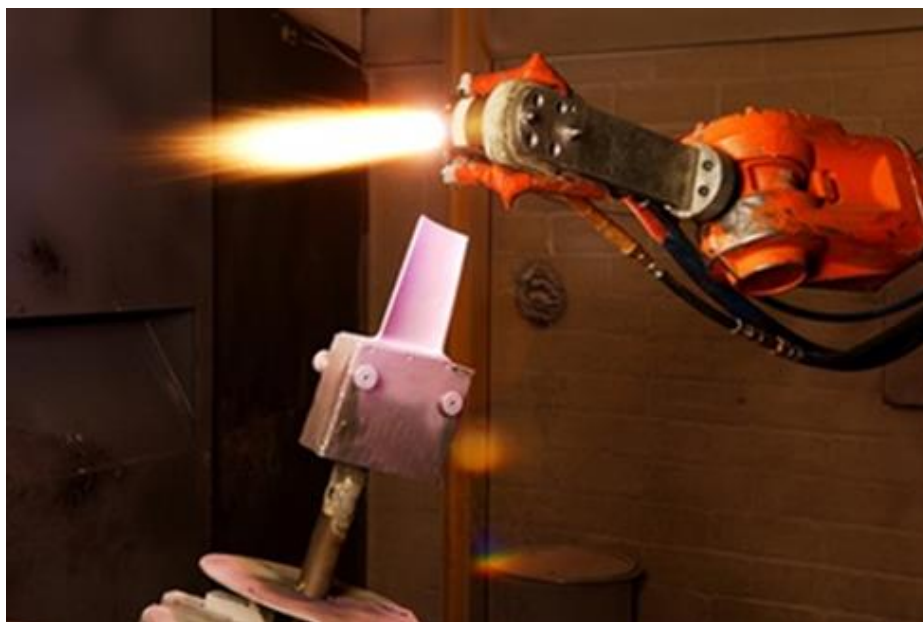
3. ábra. Egy turbinalapát bevonatolási folyamata atmoszférikus plazmaszórással [2]
