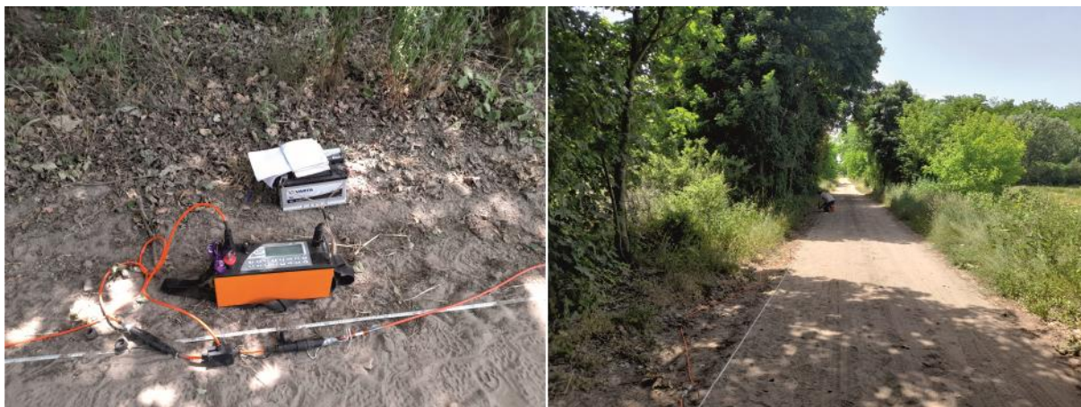
7. ábra: ERT mérés Kerekegyháza KEH 03 szelvény mentén ARES műszerrel
