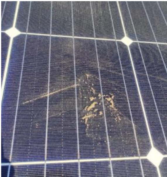
6. ábra A helyszínen megfigyelt szennyeződések (egy cella mérete 15 X 15 cm). a: érintetlen felszín vízfolyás nyomokkal; b: biológiai eredetű cementált anyag (képmagasság: 6 mm); c: felkapart soiling; d: a panel alsó peremén összegyűlt szennyeződés
