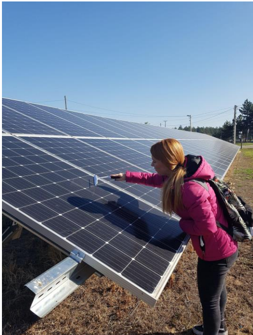
5. ábra Mintavételezés gumírozott műanyag lehúzóval (a) és műanyag szívószállal (b)
