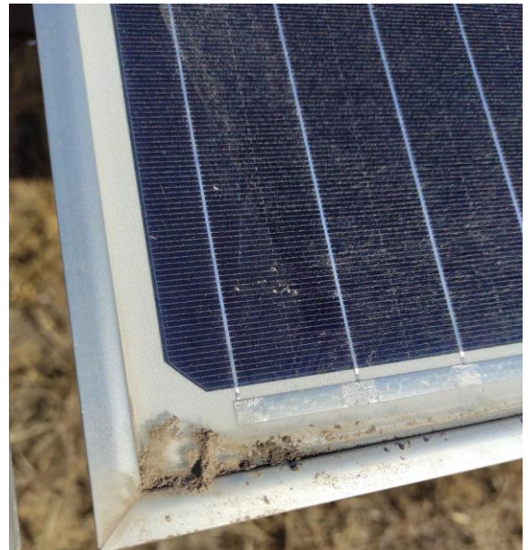
6. ábra A helyszínen megfigyelt szennyeződések (egy cella mérete 15 X 15 cm). a: érintetlen felszín vízfolyás nyomokkal; b: biológiai eredetű cementált anyag (képmagasság: 6 mm); c: felkapart soiling; d: a panel alsó peremén összegyűlt szennyeződés
