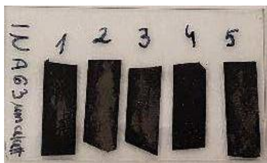
9. ábra Az elektronmikroszkóppal vizsgált A minták és talajminta 63 \mu\text{m} alatti szemcsefrakciója szénszalagra rögzítve (képszélesség: 4,5 cm)
