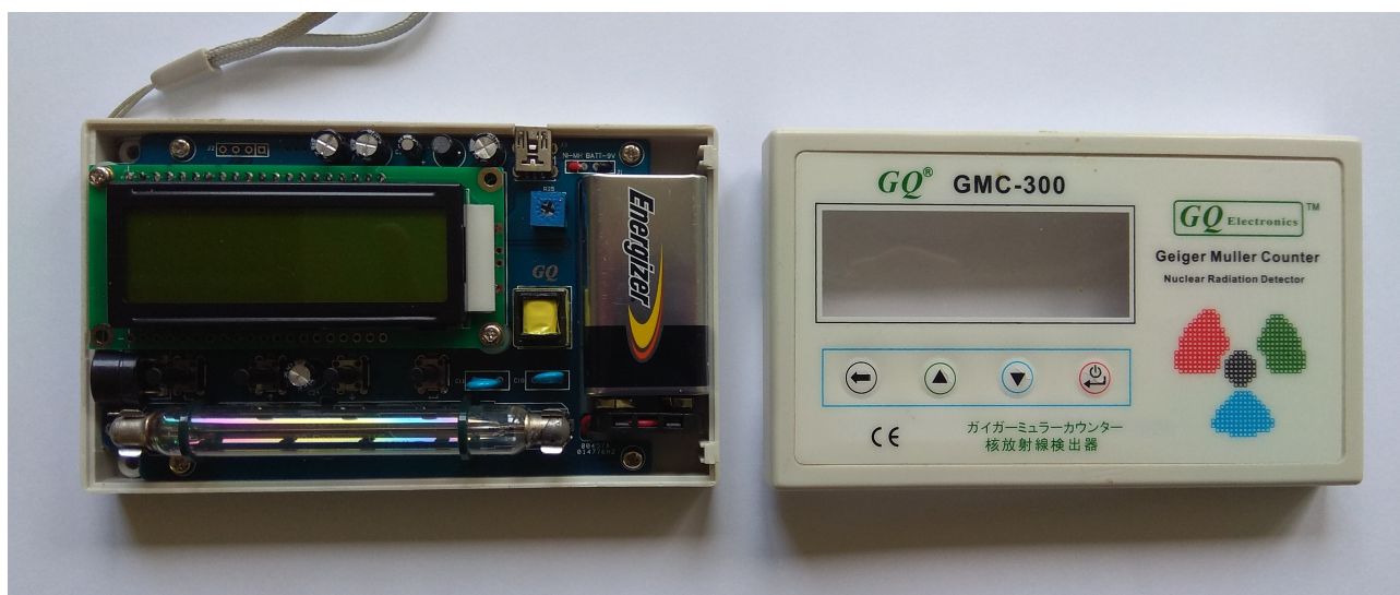
6. ábra. A mérés során felhasznált Geiger-Müller számláló benne M4011 GM-csővel.
