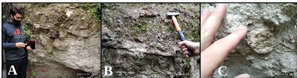
4. ábra – A II. egység feltárásai A) II. egység feltárása B) II. egység talajosodott, átmenetes felső határa C) II. egységre jellemző sárgás-szürke horzsakő (A kalapács nyélhosszúsága ~30cm, fejszélessége ~14cm)
