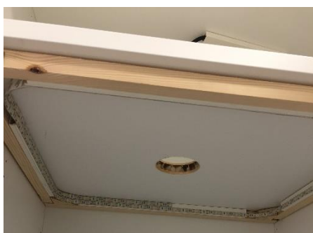
26. ábra: A mérőrendszerben kialakított megvilágítás
