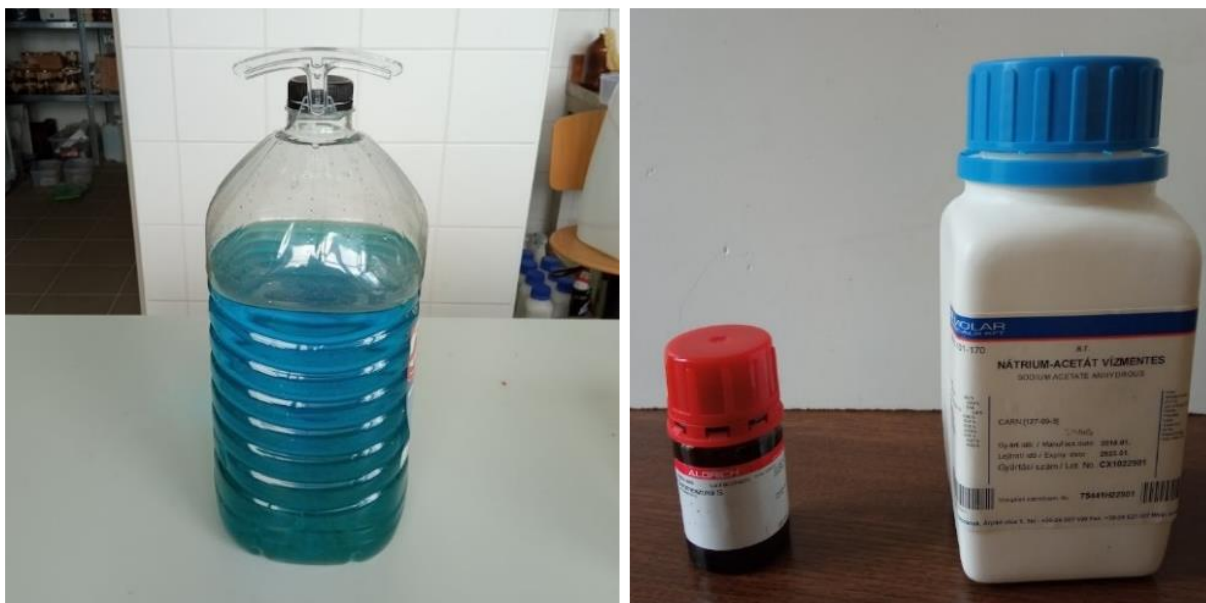
5. ábra 5%-os réz-szulfát oldat (bal) és a reagenshez használt króm-azurol S (piros kupak) és nátrium-acetát (kék kupak) (jobb)
