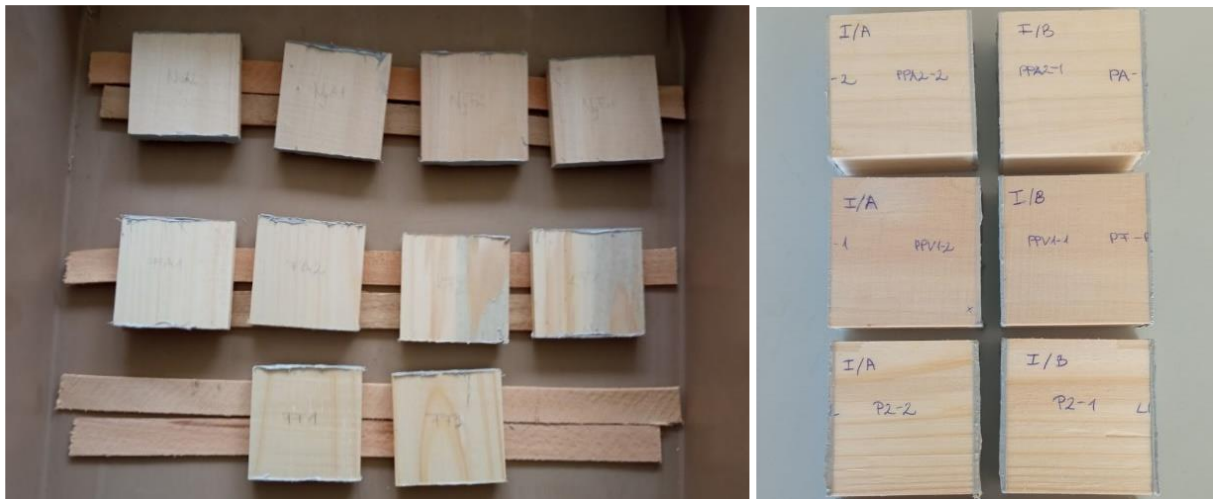
4. ábra Bütüzárt áztatási lamellák és első telítési ragasztott próbatest párok
