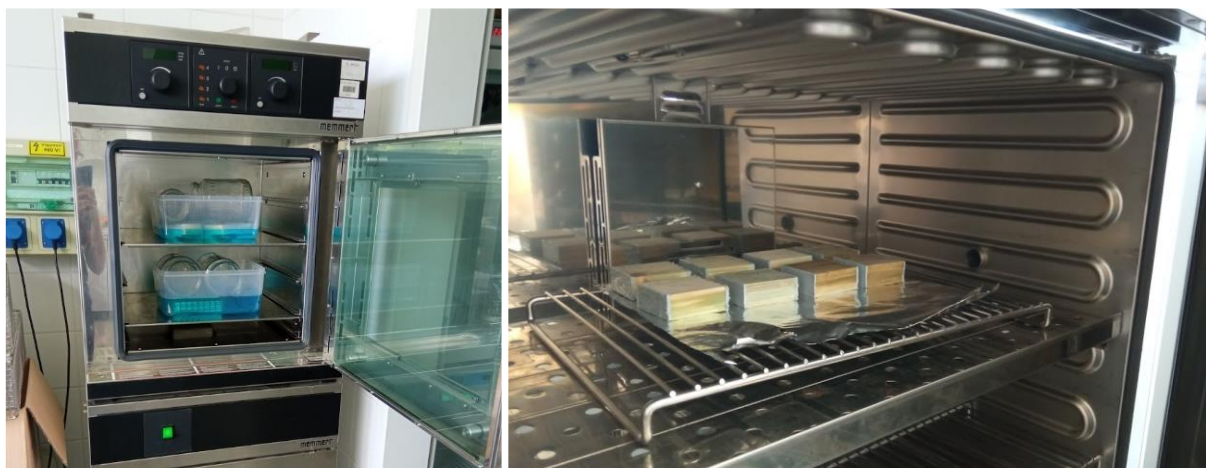
7. ábra MEMMERT vákuum szárítószekrény benne az első telítés próbatestjeivel
