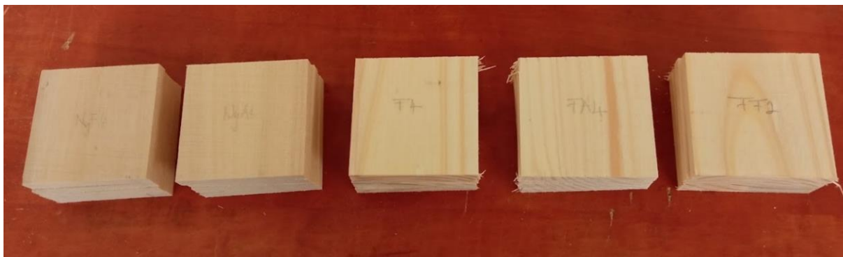
2. ábra Áztatási előkészületi próbatestek felfűrészelés után
