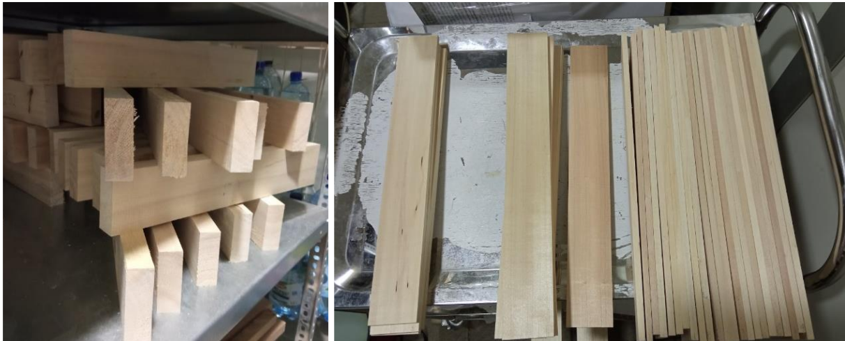
1. ábra Kezdeti Pannónia nyár anyagok (bal) és a már felfűrészelt 7 mm vastagságú lamellák válogatás során
