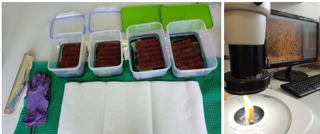
5. ábra Áztatási vizsgálat (bal) és a beszívódási mélység meghatározása sztereomikroszkóppal (jobb)
