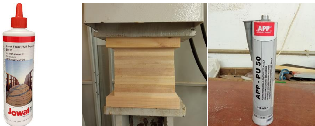
3. ábra A ragasztáshoz használt ragasztóanyag (bal), a préselési elrendezés (középső) és rugalmas tömítőanyag (jobb)
