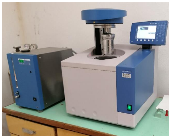
10. kép Szemléltető a kaloriméter felépítéséről és működési elvéről és az alkalmazott IKA 2000C típusú kaloriméter
