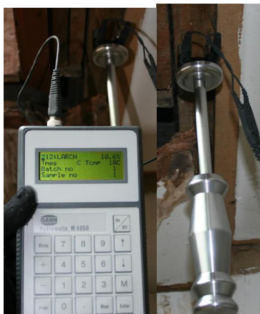
10. ábra HYDROMETTE M4050-es beütő-kalapácsos nedvességmérő
