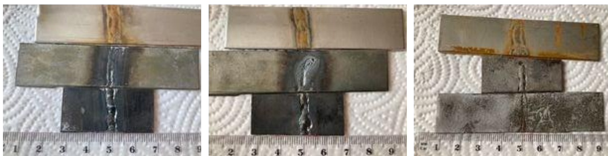
[23.kép] 30%-os oldat (72 óra) [24.kép] 4%-os oldat (72 óra) [25.kép] \text{FeCl}_3 oldat (72 óra)
