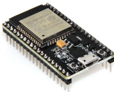
5. ábra ESP32 mikrokontroller
