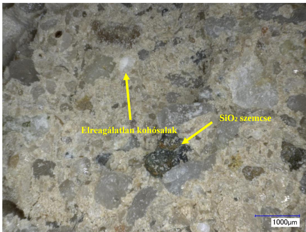
32-33. ábra: A 2x30 28N jelű minta (f), és a standard próbatest (l, 28N) törési felületének fénymikroszkópos felvétele
