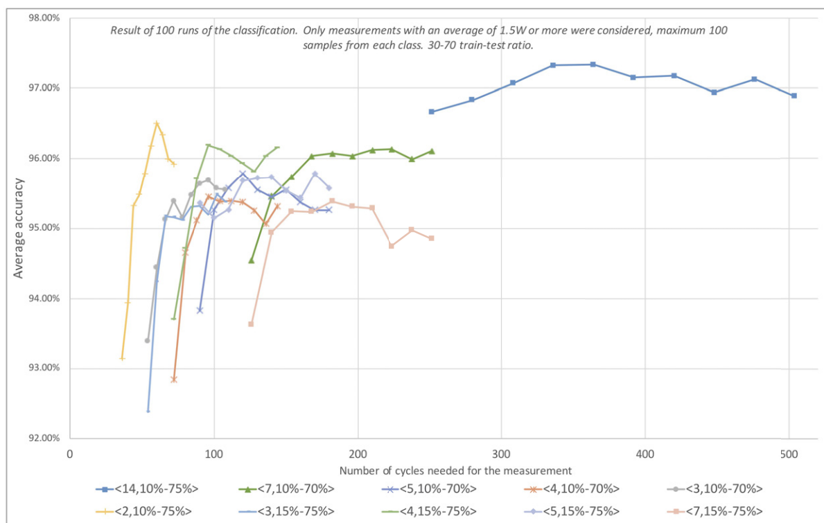
5.9. ábra. Az extrapolált mátrixokon végzett klasszifikáció eredményei grafikonon ábrázolva. (Minden USB-s eszköz külön osztályként szerepelt.) Látható, hogy az adott levágási értékhez tartozó periódusok számának ( h ) növelésével a pontosság egy idő után már nem, vagy csak minimálisan javul.
