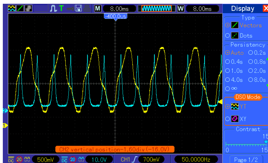
3.4. ábra. Transzformátor és Zero Crossing detektor kimenete oszcilloszkópon
