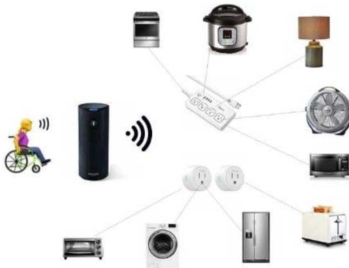
2.2. ábra. Fogyasztók hanggal történő vezérlését megvalósító hálózat. Forrás: [4]
