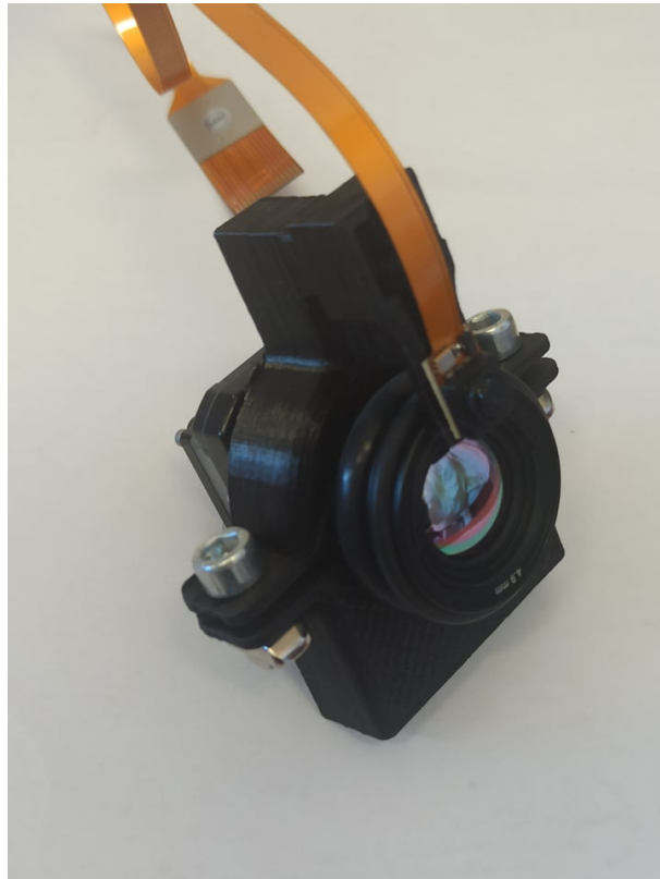
3-4. ábra. Flir Boson 640 4,9mm-es optikával és egy ráépített 5MP-es látható tartományban működő MIPI kamerával
