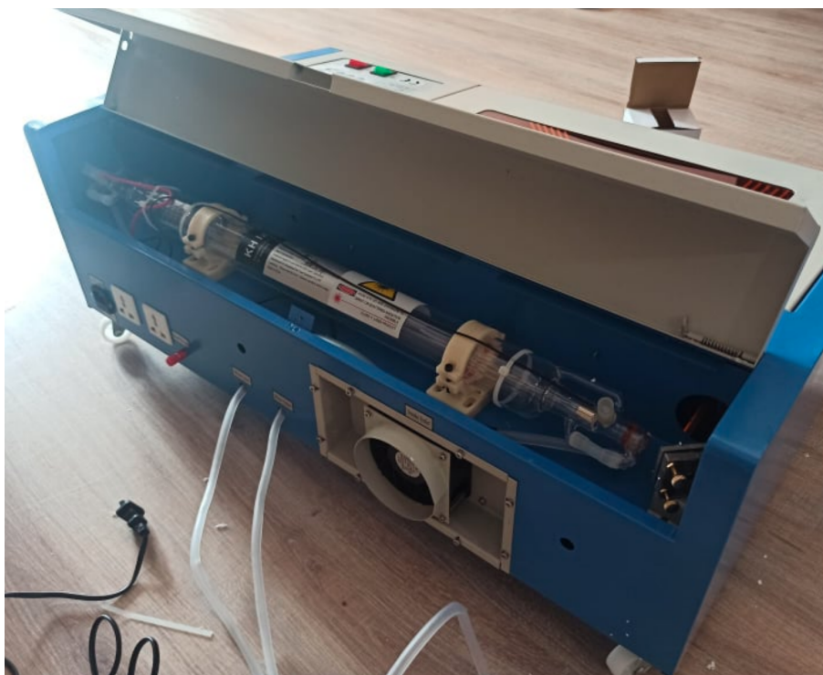
3-5. ábra. A K40-es lézerem felnyitott hátlapjal, jól látható a CO 2 lézercső
