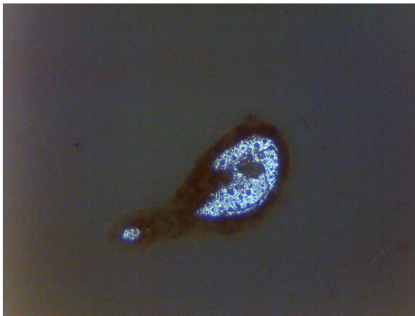
17. ábra. Hiba a tükrön (rezgő lézerdióda).
