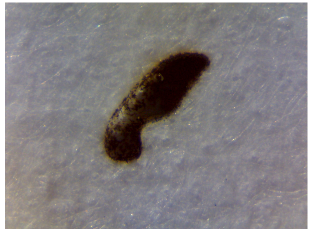
18. ábra. Hiba a papírlapon (begyúlt papírlap).
