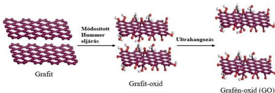
4. ábra: A grafén-oxid előállítása módosított Hummer eljárással
