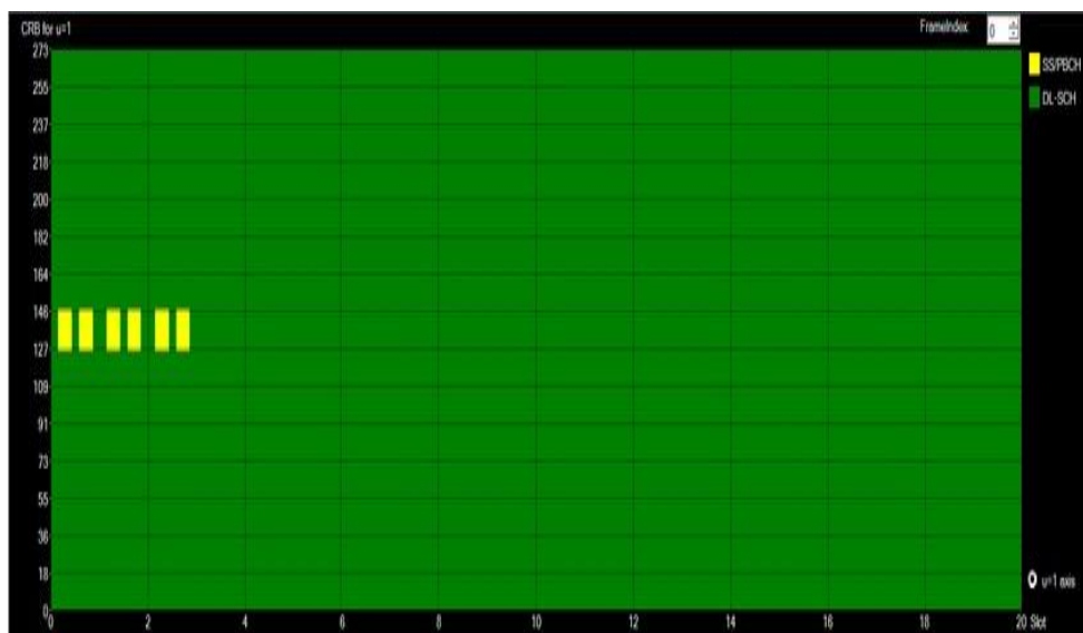
9. Ábra: FDD jel keret felépítése. A zöld blokkok az adatátvitelhez allokkált erőforrásokat jelentik [2]
