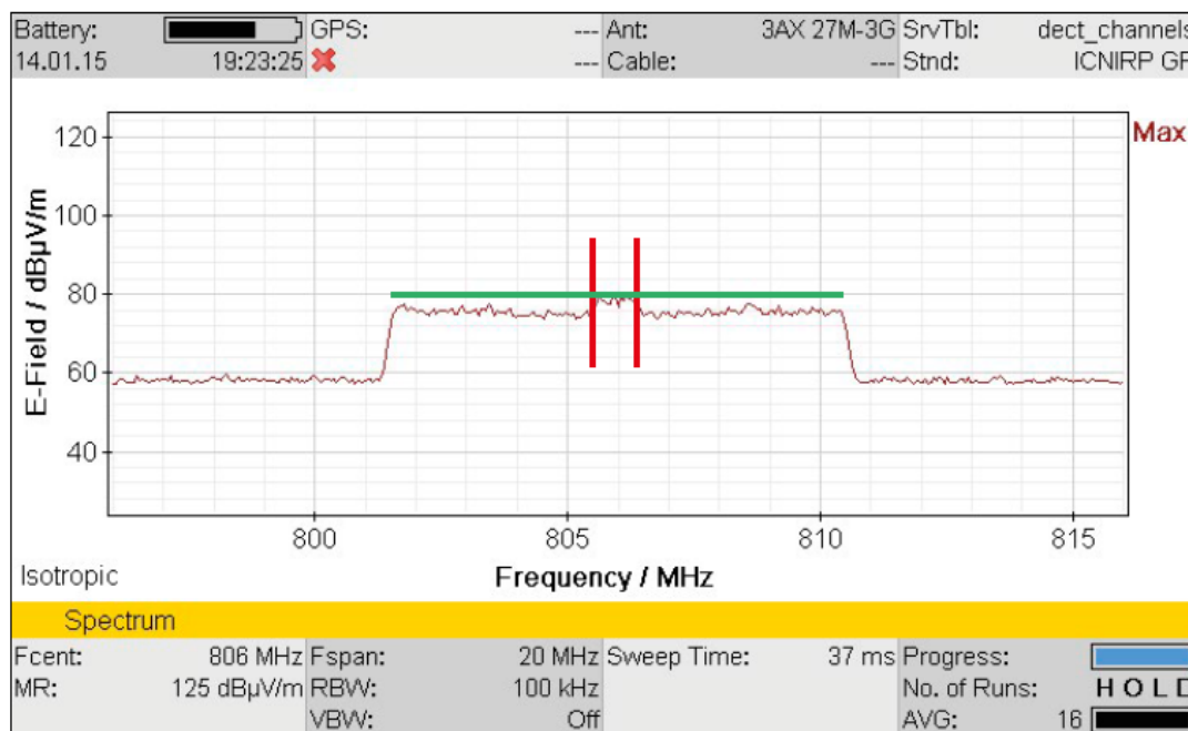
1. Ábra: 9 MHz sáv szélességű LTE spektrum, pirossal jelölt spektrumrészt a rendszeresen továbbított jelzések alkotják (P-SS, S-SS, PBCH) [1]
