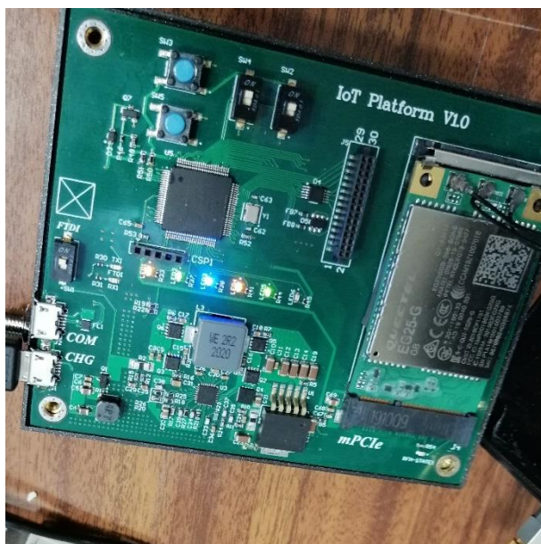
10. ábra: Állapotjelző LED-ek (balról-jobbra haladva, LED1-LED6-ig bezárólag)
