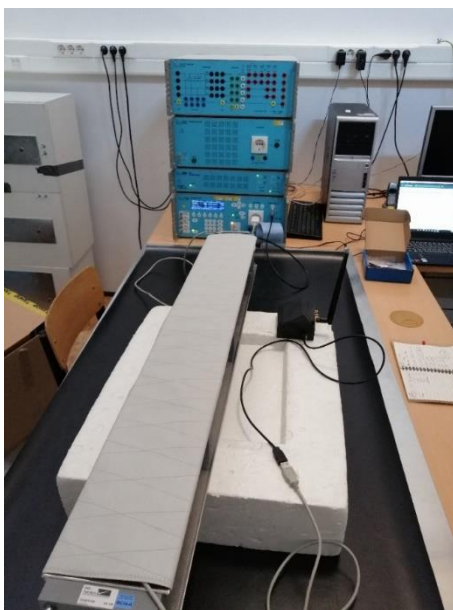
26. ábra: EFT vizsgálat, kapacitív csatoló használata
