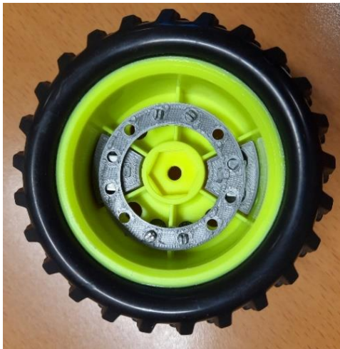
26. ábra Mágnes kerekre erősítése 3D nyomtatott elemekkel
