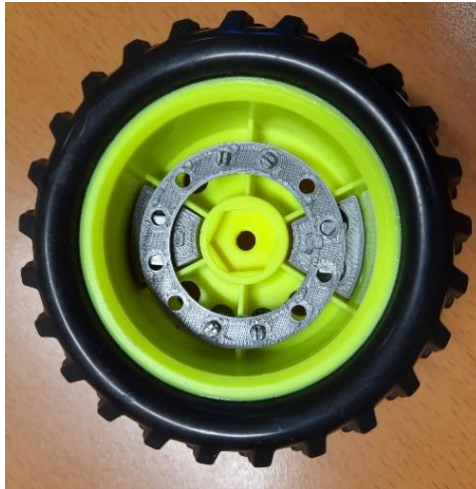
26. ábra Mágnes kerekre erősítése 3D nyomtatott elemekkel
