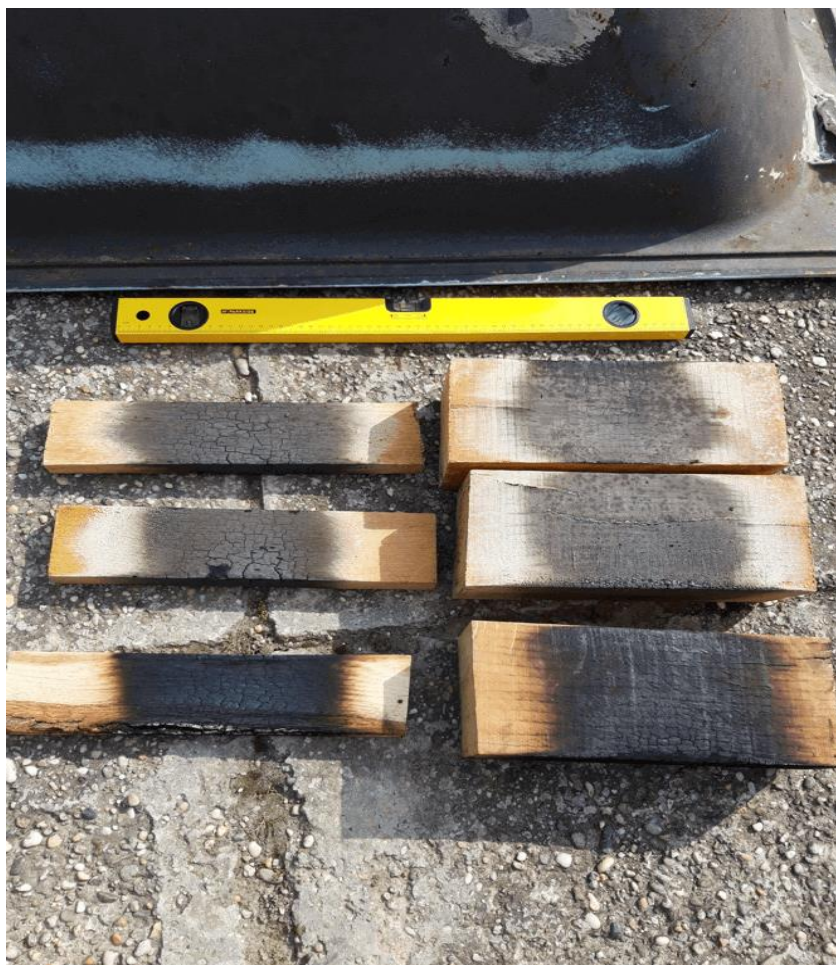
14. ábra A tölgyfa 60 másodperces előégetése, készítette: a szerző 2022.03.10. 10:27
