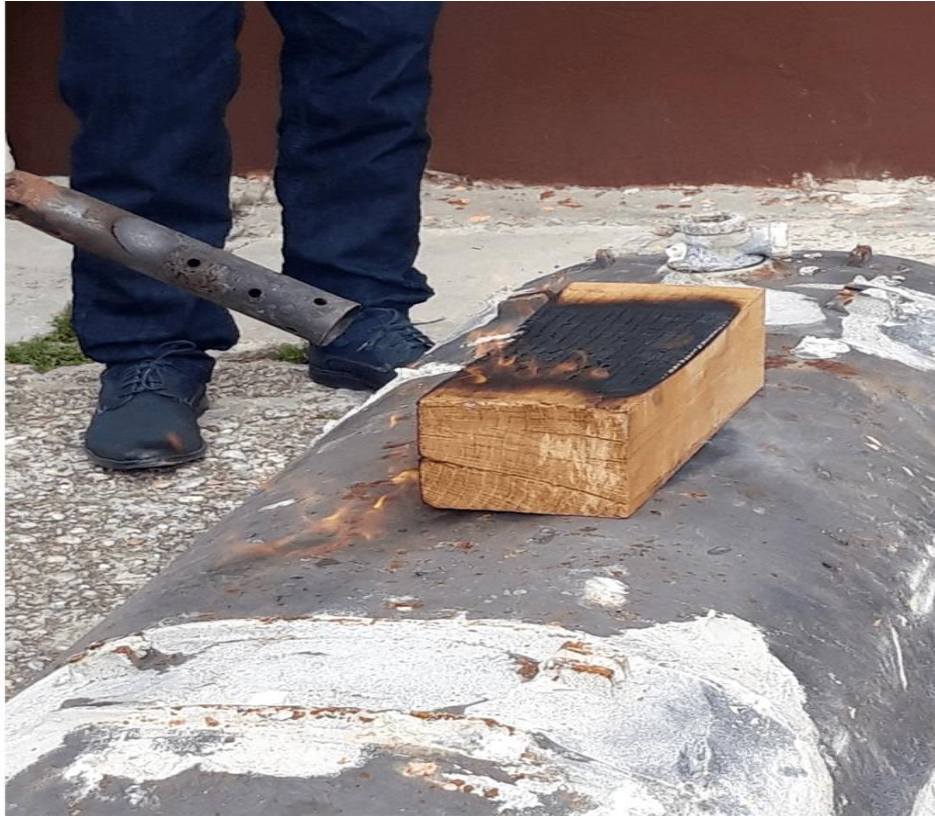
15. ábra 12x10 Natúr tölgyfa égetése, készítette: a szerző 2022.03.10. 10:22
