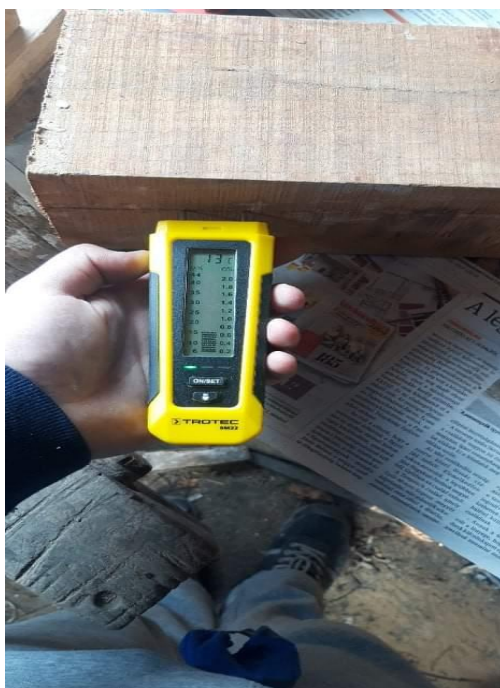
13. ábra A még nem kezelt 12x10-es tölgyfadarab nedvességtartalma <15 tf% Készítette: A szerző 2022.02.07. 14:08
