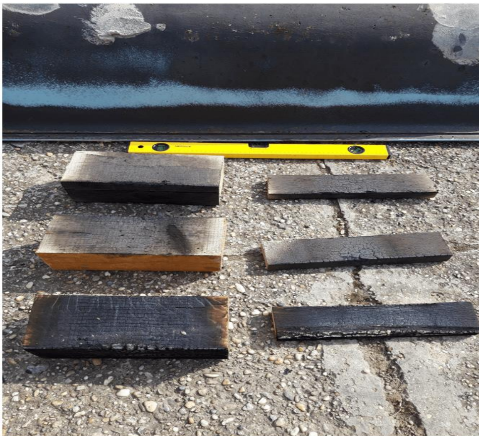
16. ábra Tölgyfák 180 másodpercnyi égetést követően, készítette: a szerző 2022.03.10. 10:54
