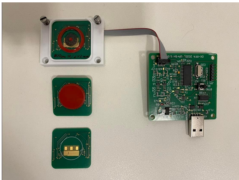
5. ábra: szenzor panelek (balra) és a jelfeldolgozó elektronika, mely a kiindulási alapot adta
