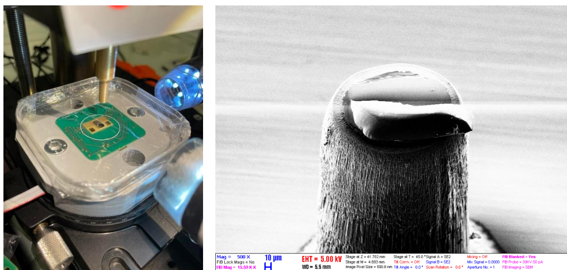
14. ábra: Korongos erőmérő a steril fóliával (balra) és a kiszakadt SI oszlop, rajta a membrán egy darabjával (jobbra)
