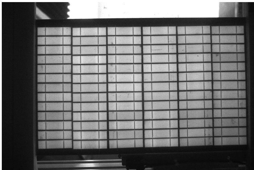
3.2. ábra. ELDDS - egy napelem panelről a gyártói EL tesztelő berendezésben készült felvétel
