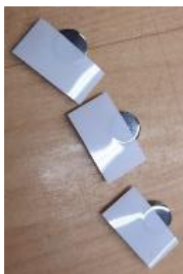
12. ábra – Próbatestek maszkolása alumínium-oxid szórás előtt
