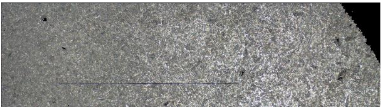
27. ábra – 3D nyomtatott próbatest \text{ZrO}_2 -al szórt felületrészlete
