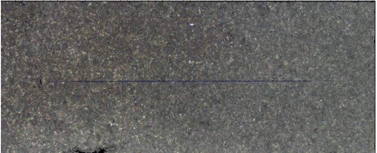
30. ábra – 3D nyomtatott próbatest \text{ZrO}_2 -al szórt és HF savval maratott felületrészlete
