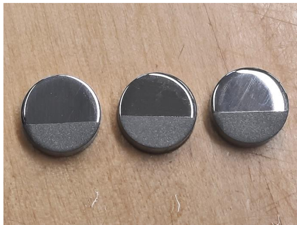
14. ábra – Próbatetek alumínium-oxid homokszórás és tisztítás után.
