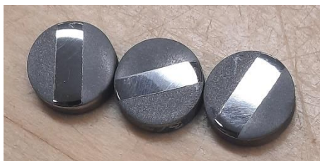
15. ábra – Próbatestek polírozás, alumínium-oxid és zirkónium-dioxid szórás után. A különbözően kezelt felületek jól elkülöníthetők.
