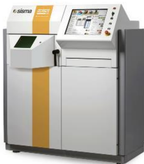
5. ábra - SISMA MYSINT 100 RM típusú fém 3Dnyomtató (LMF) [16]
