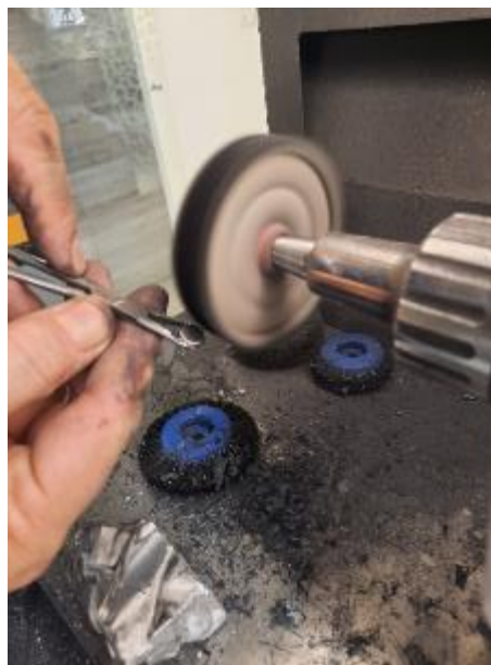
10. ábra – Próbatétel csiszolása a Wassermann WP-EX 2000 típusú polírozógéppel
