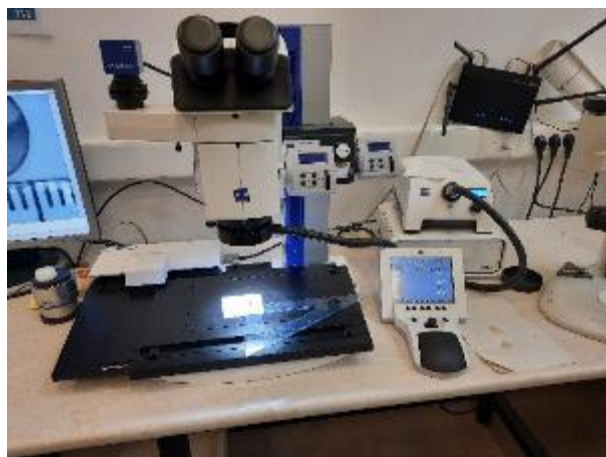
7. ábra – A Széchenyi István egyetem Anyagtudományi és Technológiai Tanszék laborjának ZEISS Axio Imager A1 típusú optikai sztereomikroszkópja
