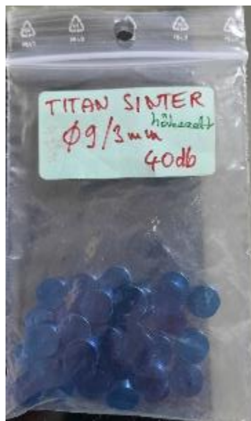
6. ábra – 3D nyomtatott próbatestek előgyártmányai kék színűre oxidálva
