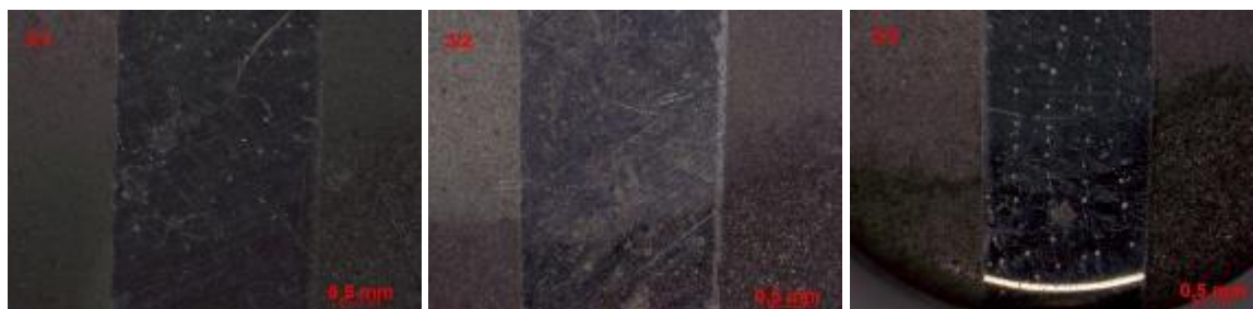
18. ábra - A 3D nyomtatott próbatestek teljes felületkezelés után, 50-szeres nagyítás alatt
