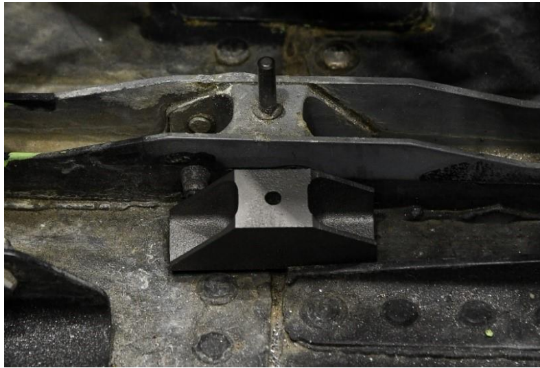
4. ábra: Az F-22 Raptor eredeti és a 3D nyomtatott alkatrészei[19.]
