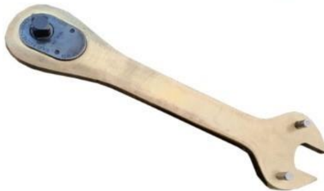
6. ábra: Az M242 könnyű páncélozott jármű géppuskájának javítására szolgáló 3D nyomtatott szerszám[22.]
