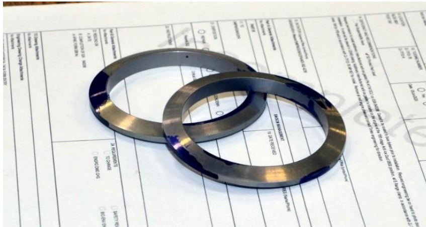
5. ábra: ATF33-P103 hajtómű 3D nyomtatott tömítőgyűrűje[17.]
