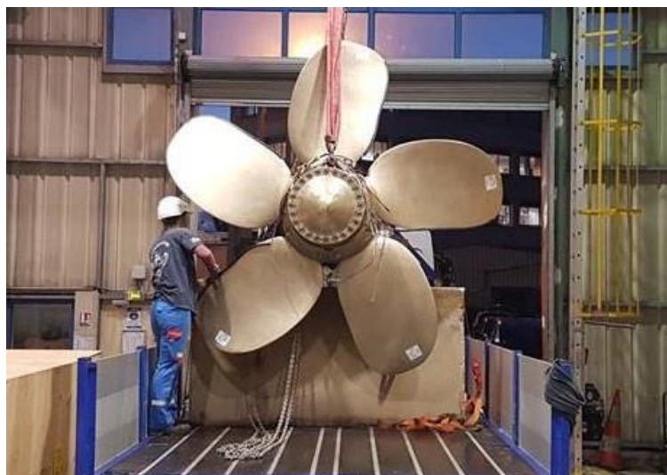
7. ábra: A francia Naval Group által gyártott 3D nyomtatott hajócsavar[23.]
