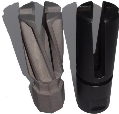
18. ábra: A 3D nyomtatott és az eredeti alkatrész
