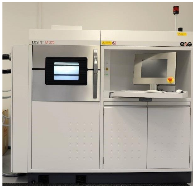
8. ábra: EOSINT M270 DMLS berendezés a Széchenyi István Egyetemen
