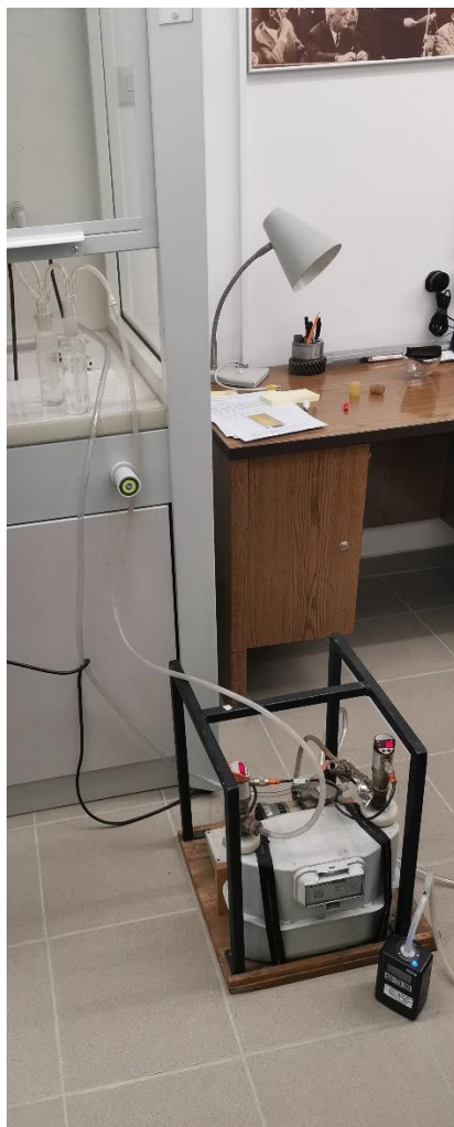
18. ábra: A véggázmintavevő kör forrás: saját felvétel
