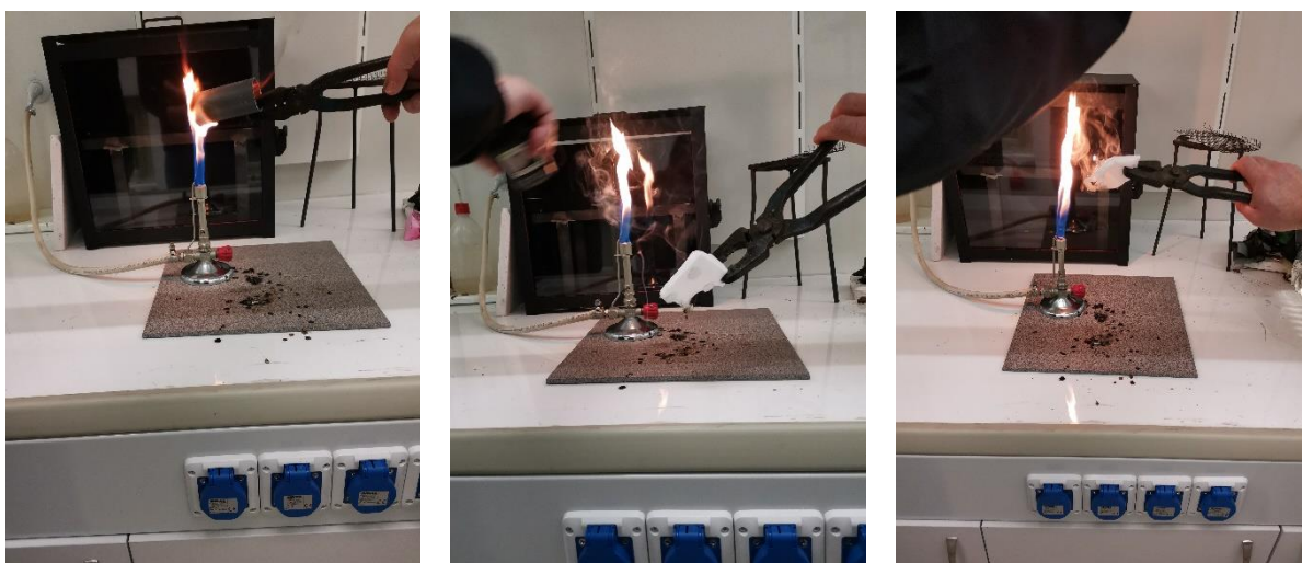
15. ábra: A PVC, PE és PS minták égetése, keletkező égéstermék összetételének mérése a multigáz érzékelővel, forrás: saját felvétel
