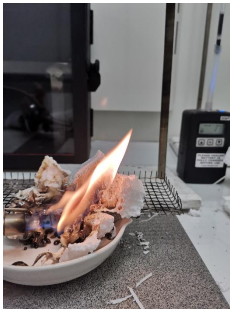
24. ábra: A polisztirol minta égetése és mintavétele
