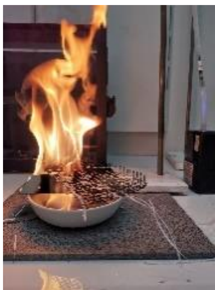
23. ábra: A polietilén minta égetése forrás: saját felvétel
