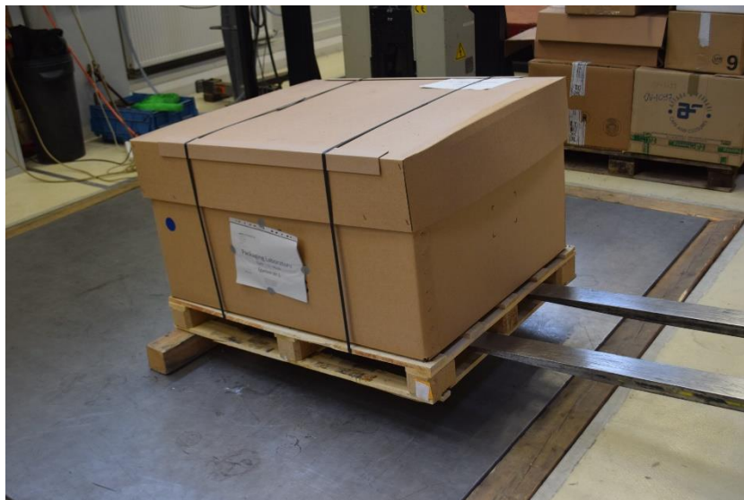
5. ábra: Billentéses vizsgálat
