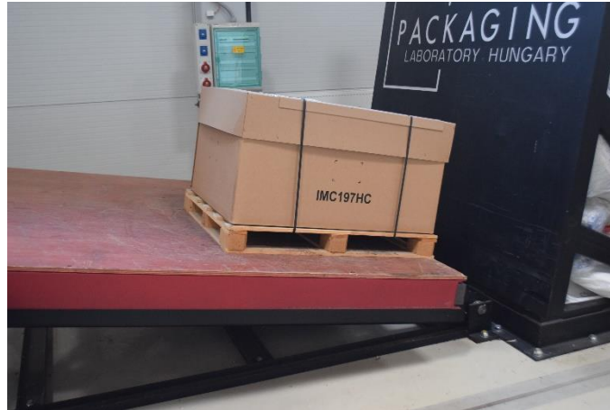
4. ábra: Lejtőpályás ütközés vizsgálat
