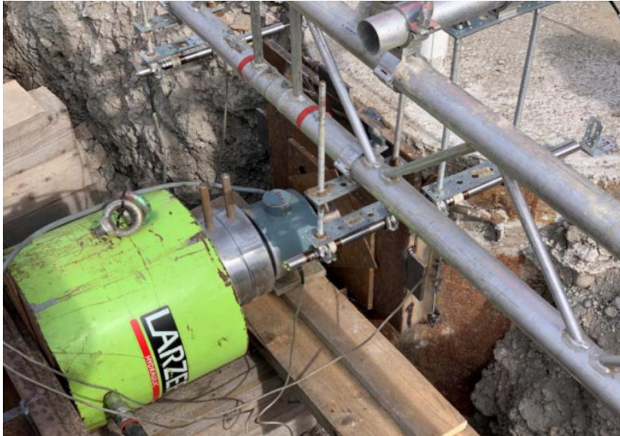
34. ábra: A dolgozatban vizsgált vízszintes próbaterhelés (HBM Kft., 2021)
