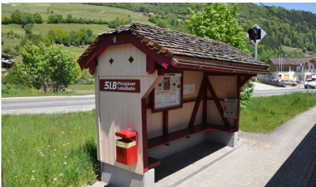
8. ábra: Burk megállóhely a Pinzgauer Lokalbahn vonalán. Jól látható az esőbeálló jobb oldalán a felszállásjelző készülék és a hozzá tartozó jelző. (Forrás: Dr. Michael Alexander Populorum: Railway + Mobility Research Austria 2018)
