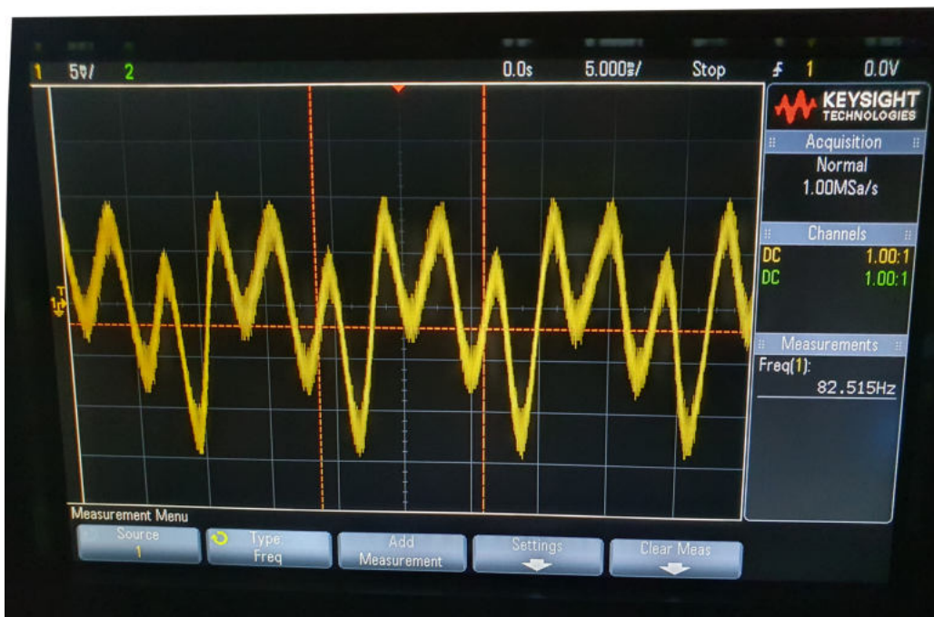
19. ábra: E_2 -s hang oszcilloszkópon mérve.
