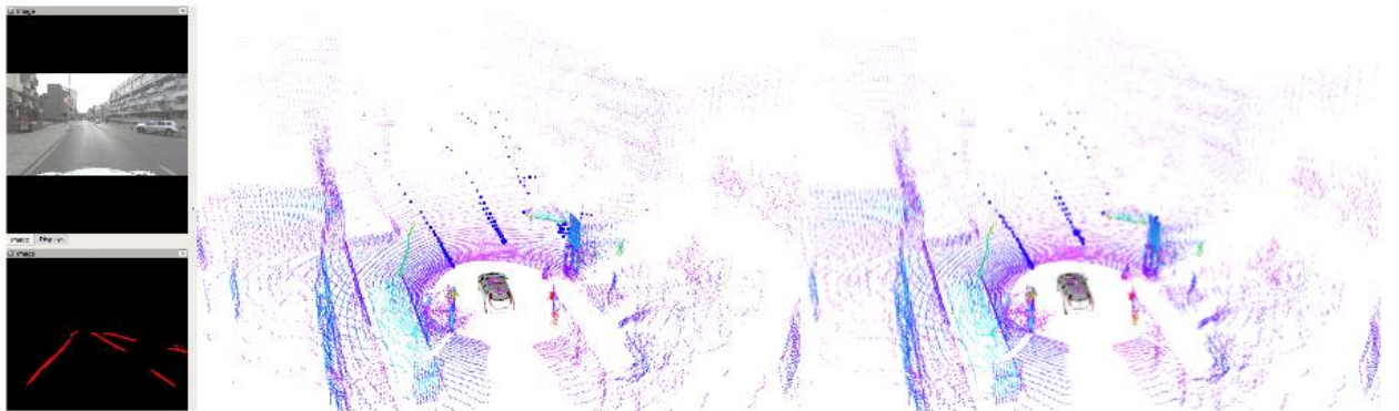
15. ábra : Fúzionált pontok az első forgalmi szituációban nyersen (bal), és szűrve (jobb)
