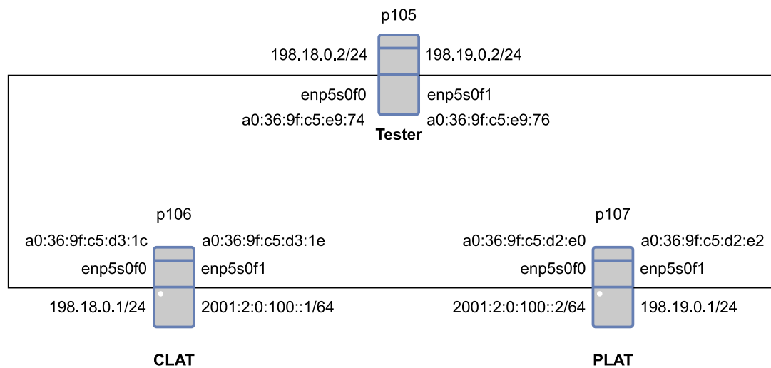
16. ábra: 464XLAT mérési konfiguráció
