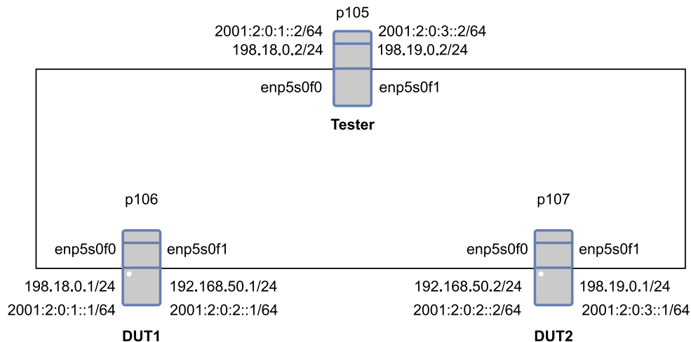
14. ábra: Mérési összeállítás csomagtovábbítás méréshez 3 szerverrel
