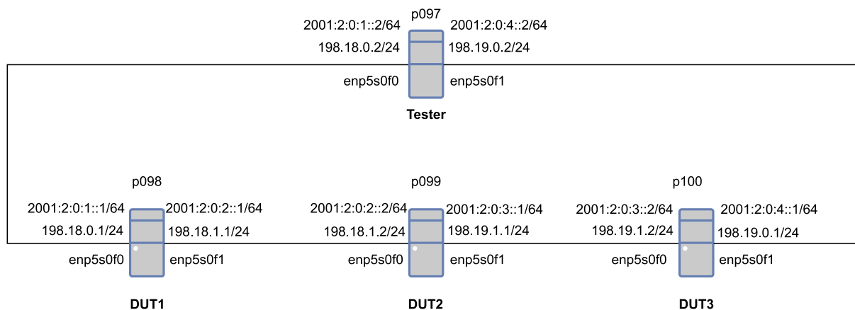
15. ábra: Mérési összeállítás csomagtovábbítás méréshez 4 szerverrel
