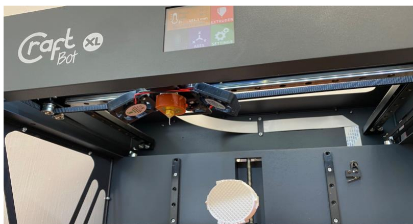
8. ábra: 3D nyomtató - PLA filament extrudálás, Forrás: Saját forrás
