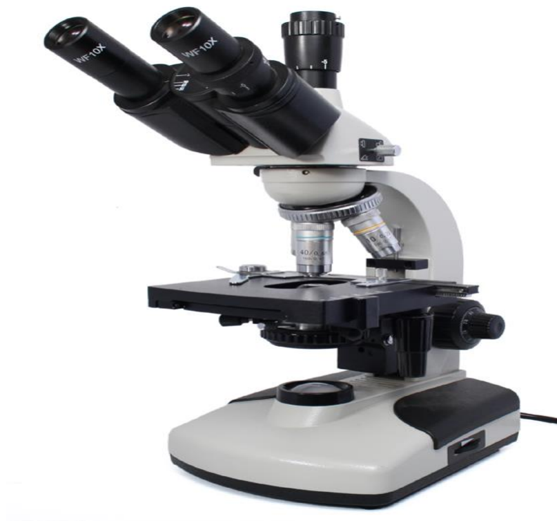
1. kép Egy Scopium SXP-151T-LED biológiai mikroszkóp trinokuláris fellej ellátva. 1
