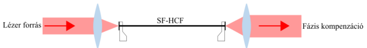
9. ábra. AZ SF-HCF poszt-kompressziós elrendezés sematikus vázlata. Az ábra egyszerűsítése céljából az optikai szálba való fókuszálás majd az azt elhagyó nyaláb kollimációja esetében gömbtüköröt lencsével helyettesítettem.
