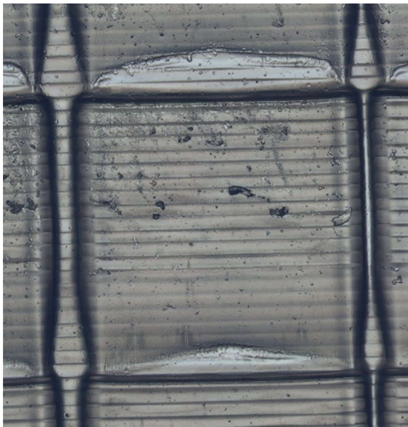
4.5.10 ábra - A negatív blokk elzáródását okozó fogak. Az ábrán látható, hogy a középben lévő pozitív blokk alatti negatív blokk nem rendelkezik oldalsó peremmel, de felső peremének fogai leérnek az alsóig, így azok az oldalakat elzáródását okozza. A felette lévő negatív blokk esetén a fogak nem zárják el az oldalakat, azonban méreteiknek köszönhetően a blokk magassága itt jelentősen lecsökkent.
