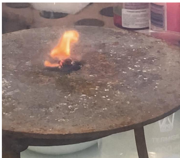
[9.kép] A felhasznált alumínium lemez és első kísérlet. A szilárd hajtóanyag égéstesztje.
