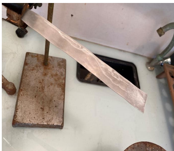
[9.kép] A felhasznált alumínium lemez és első kísérlet. A szilárd hajtóanyag égéstesztje.
