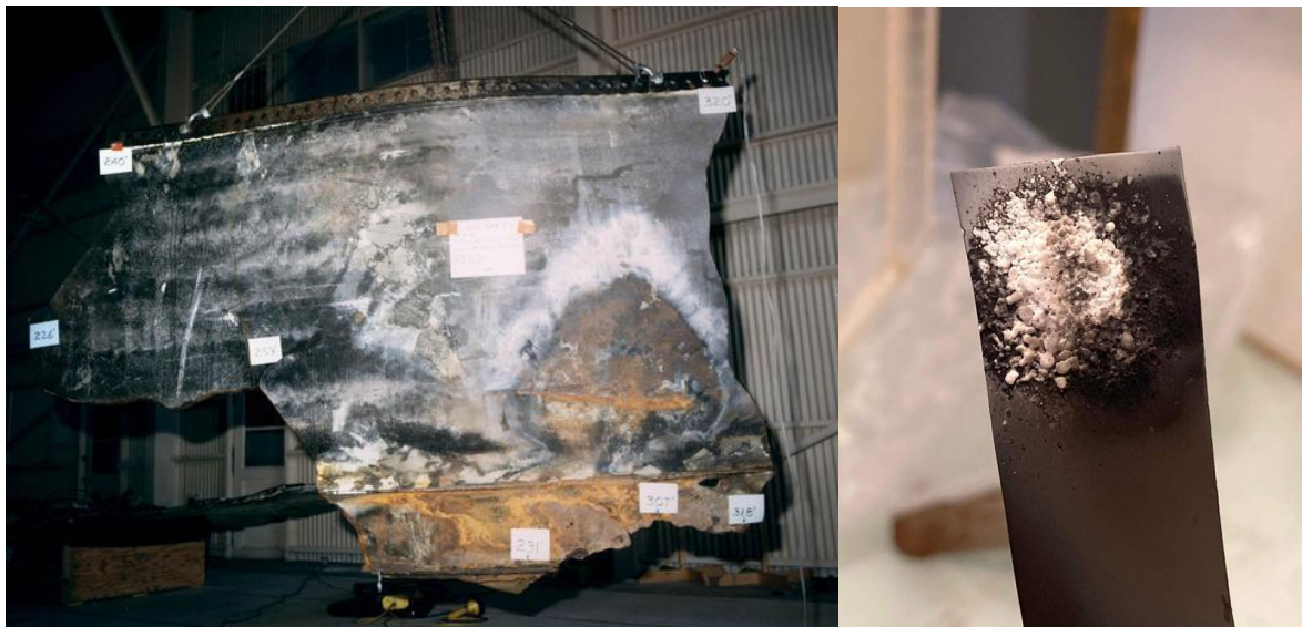
[12.kép] Bal oldalon a Challenger űrsikló azon alkatrésze, ahol a katasztrófáért felelős gyűrű volt. Jobb oldalon pedig az általunk végrehajtott kísérlet eredménye. Mindkét képen jól látható a megolvadt, szerkezetileg meggyengült alumínium.
