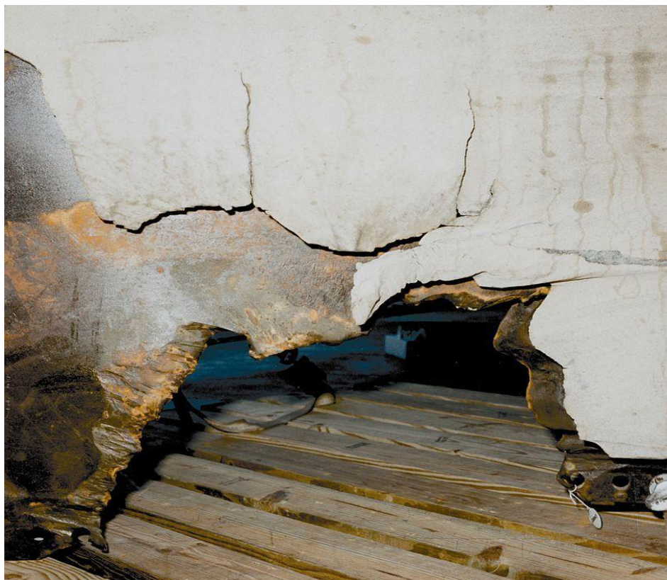
[8.kép] A hibás nyomásálló gyűrű következtében keletkezett lyuk a jobb oldali segédrakétán.
