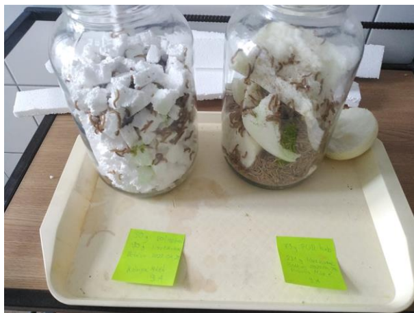
12. ábra Kísérleti elrendezés polisztirol és poliuretán lisztkecskékkel történő biodegradációjának vizsgálatához.
