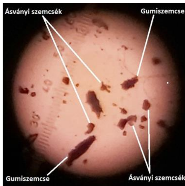
Útanyag szemcsék polarizált fényben (a léptéken a kis osztásközök 10 \mu\text{m} -t jelentenek)
