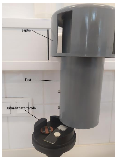
A mintavételi „felületek” elhelyezkedése a tubus aljában
