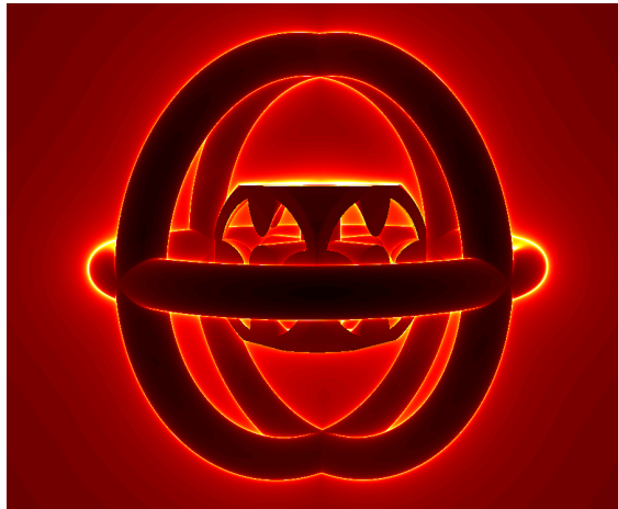
3.5. ábra. Sphere tracing során megtett lépések száma. Egy pont minél világosabb, annál közelebb volt a lépésszám a maximumhoz. (Maximum: 100)
